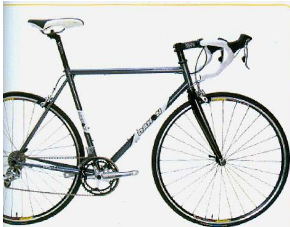
●スペック フレーム/リッチー・ブレーカウエイ、WCSスチール フォーク/カーボン メーンコンポ/シマノ・アルテグラ ハンドル/リッチー・コンプ チェーンホイール/トラバティブ・ELITA 53×39T スプロケット/12~26T (9S) リム/アメリカンクラシック タイヤ/シュワルベ・ステルビオ700×23C サドル/フィジーク・ナイゼン 本誌実測重量/8.4kg (520mm)
