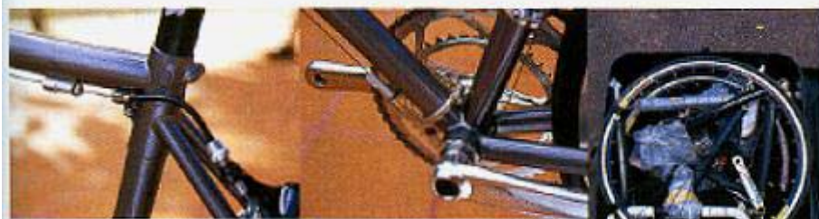
●スペック フレーム/リッチー・ブレーカウエイ、WCSスチール フォーク/カーボン メーンコンポ/シマノ・アルテグラ ハンドル/リッチー・コンプ チェーンホイール/トラバティブ・ELITA 53×39T スプロケット/12~26T (9S) リム/アメリカンクラシック タイヤ/シュワルベ・ステルビオ700×23C サドル/フィジーク・ナイゼン 本誌実測重量/8.4kg (520mm)
